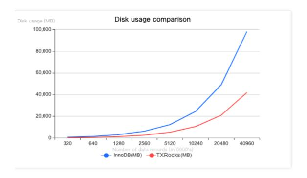
**测试场景**:两种存储引擎均使用默认配置,使用 SysBench 的默认表结构,每张表包含80万条记录,表总数从4张逐渐增长到512张。
