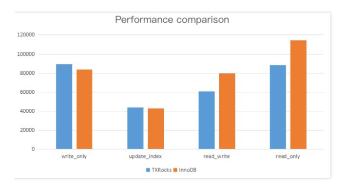
**测试场景**:实例8核32GB场景,6张表500万行数据,每个测试均重启后冷启动测试,每个 case 跑1200秒。 上图为测试场景条件下分别使用 TXRocks 和 InnoDB 存储引擎时的性能对比,通过对比可以发现 TXRocks 和 InnoDB 性能相近。
